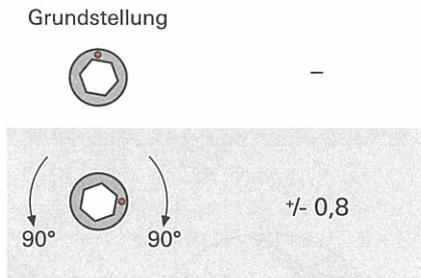
**Schließzapfen P** Verstellweg in ° Anpressdruckverstellung in mm
